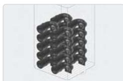
**Posizionamento efficiente delle parti per una densità di stampa ottimale**
